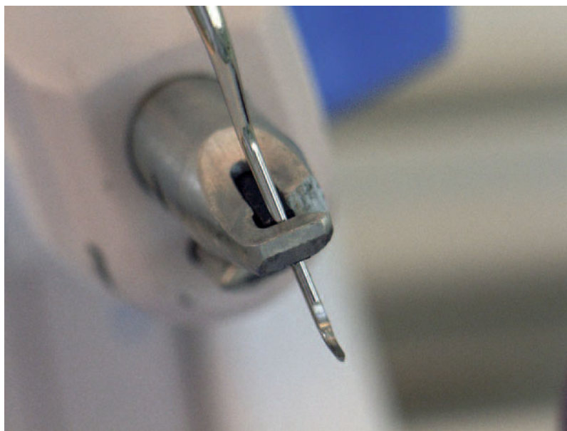
Figuur 1.3 Gefixeerde slijphoek bij machinaal slijpen.
