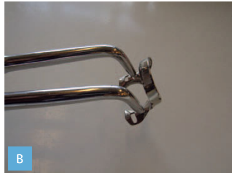
Figuur 3.4a Positie cofferdamklem: beugel bevindt zich altijd vóór de tang.
